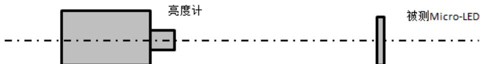
图1 亮度计测量几何示意图
