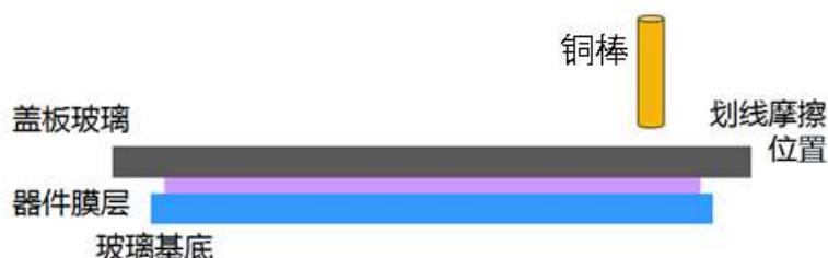
图3 摩擦静电能力测试示意图
