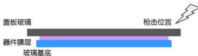
图2 枪击静电能力测试示意图
