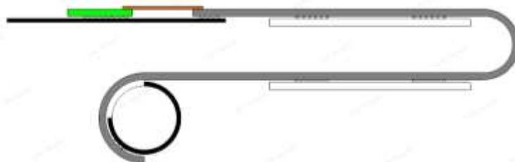
图 7 卷曲-折叠试验示意图
